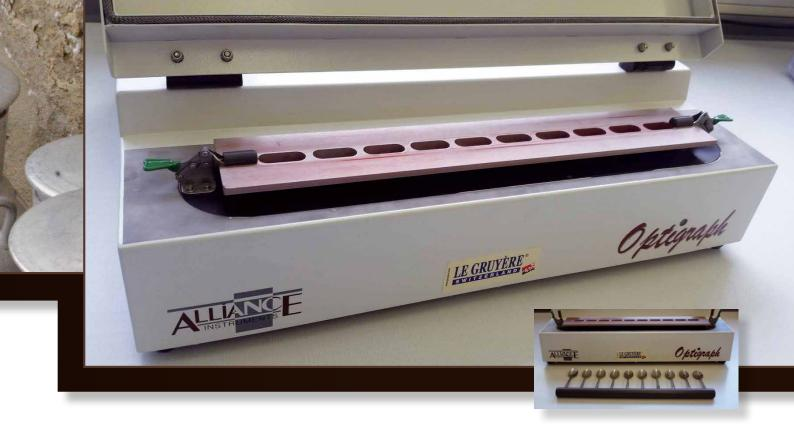
té du caillé à 30 minutes. L'analyse de l'Optigraphe permet de déterminer plusieurs catégories de lait. Ainsi, pour la fabrication d'un Gruyère AOP, 6 classes sont recensées.
